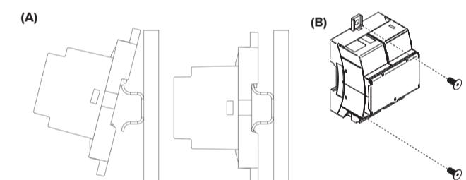
(ES) Montaje sobre carril DIN (A) o en superficie (B). La ubicación y montaje de este módulo debe cumplir la normativa electrónica vigente. Para retirar el módulo, tire de la lengüeta hacia abajo para liberarlo.
