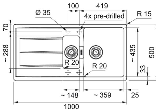
Evier CENTRO, CNG 651 Blanc Artic, à encastrer 1000x500 mm. Sa matière Fraganite résiste aux rayures, aux chocs et aux taches. Vidage automatique, Trop plein design inox avec sa bonde et son bouton rotatif. Tous ces accessoires qui permettent une installation en toute tranquillité.
