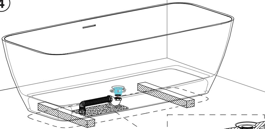
Positionnez la baignoire sur deux blocs de bois au-dessus des connexions pour le tuyau d'évacuation. Remplissez la baignoire avec de l'eau et assurez-vous qu'il n'y ait pas de fuite.
