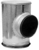
Tés souches insonorisés à joint. Permet la liaison entre un réseau vertical et un réseau horizontal (en comble ou terrasse). Etanchéité Classe C. Epaisseur laine de roche: 25mm. Mâle / mâle.
